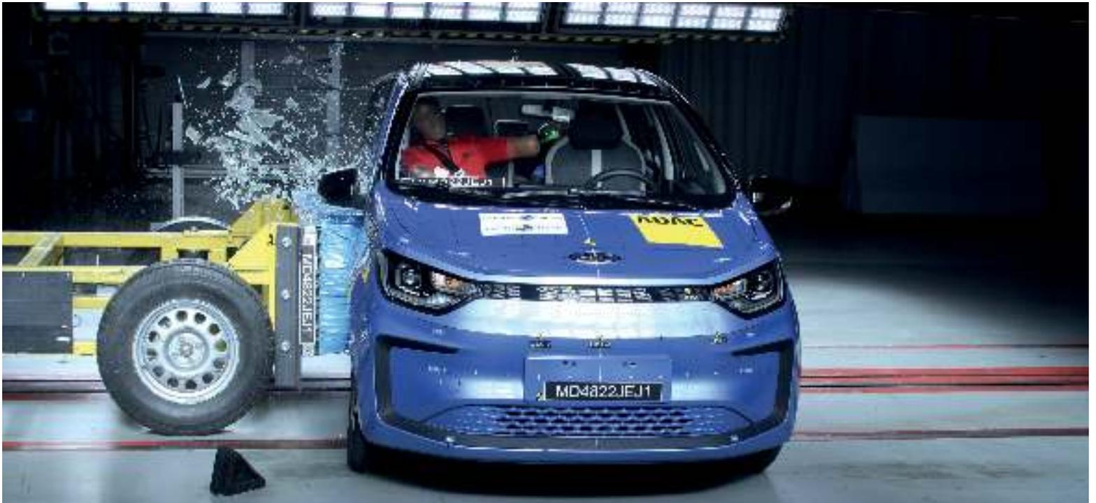
El choque con un poste es una prueba diseñada para evaluar la seguridad del piloto contra un objeto de gran magnitud y la resistencia de la estructura del vehículo en este tipo de impacto.
